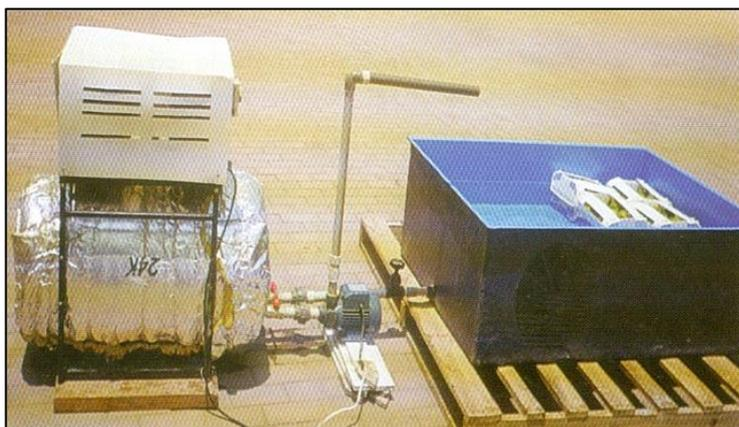
**Foto 13** Hidrogenfriador diseñado en la Estación Experimental Donoso - CICH - KM - Huaral.
