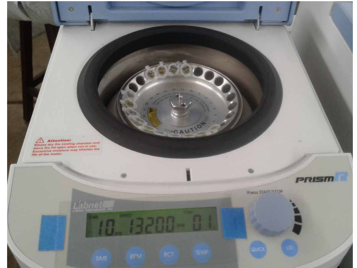
Figura 10. Centrifugación para la separación del ADN.
