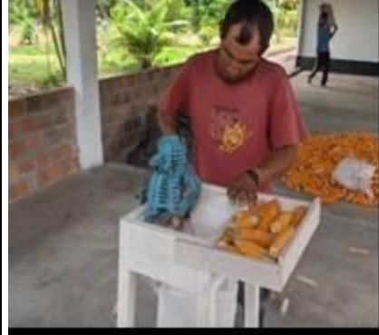
Fig. 14: Desgrane manual/ mecánico
