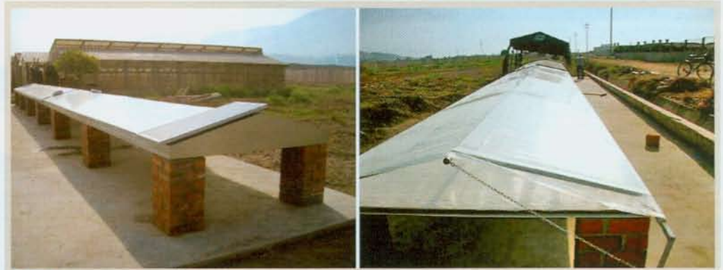
EN OPERACIÓN: Vistas del deshidratador solar tipo túnel instalado en la EEA "Donoso" de Huaral.
