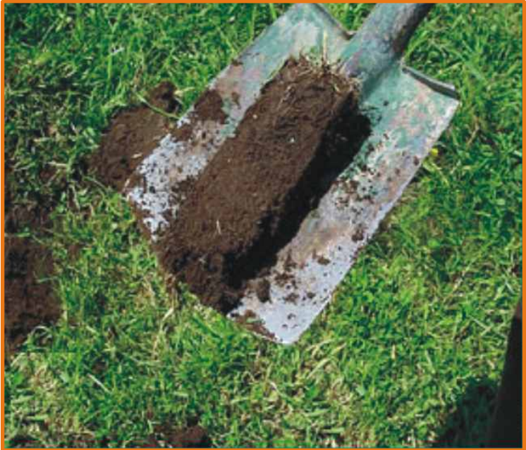
Foto 1. Submuestra en la parte central de la pala
