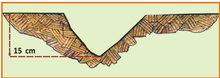
Figura 4. Hoyo listo en forma de "V"
