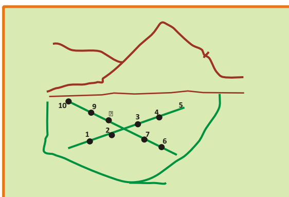
Figura 3. Toma de submuestra en forma de cruz
