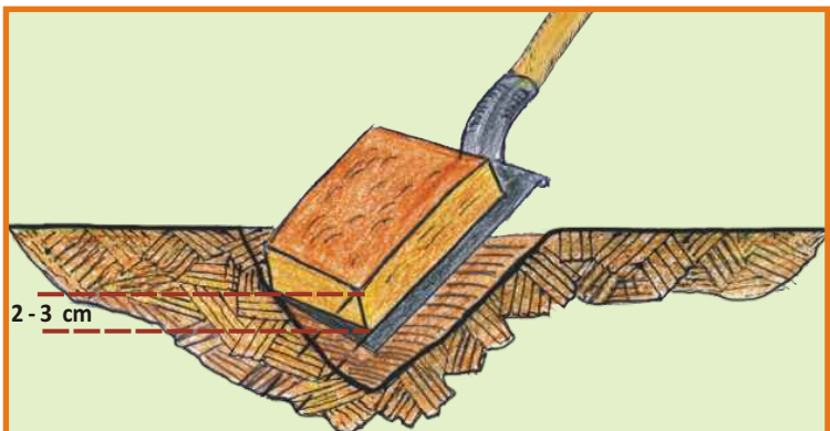
Figura 5. Hoyo con lampa y ancho de tajada de suelo
