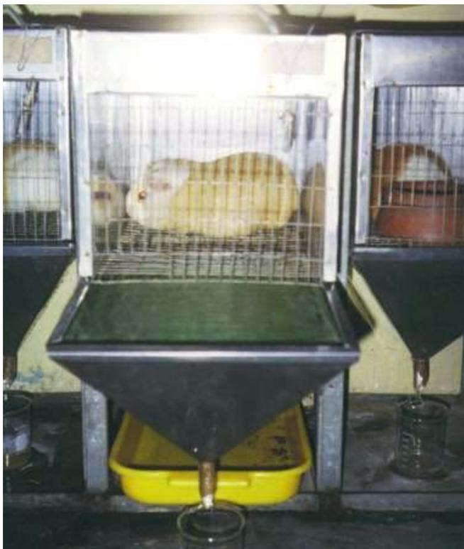
**Foto 8: Jaula metabólica para pruebas de digestibilidad**
