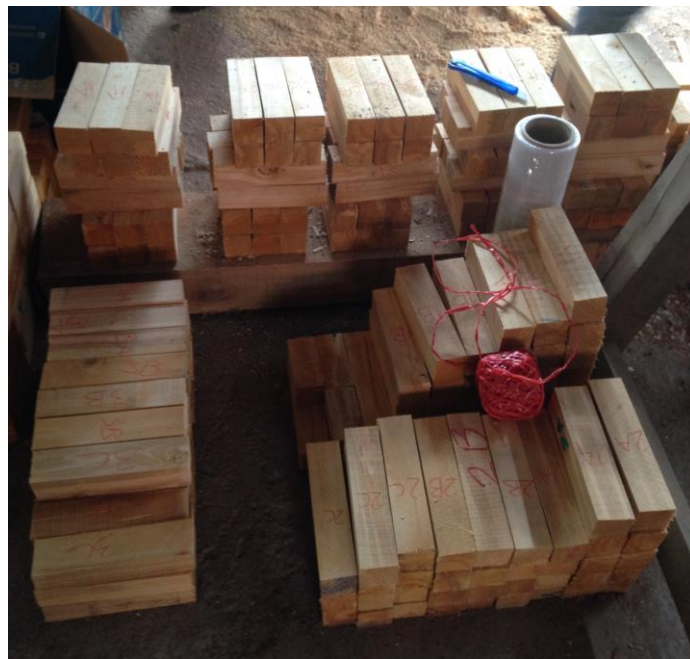
Figura 6: Codificación de probetas de compresión paralela, compresión perpendicular, dureza
