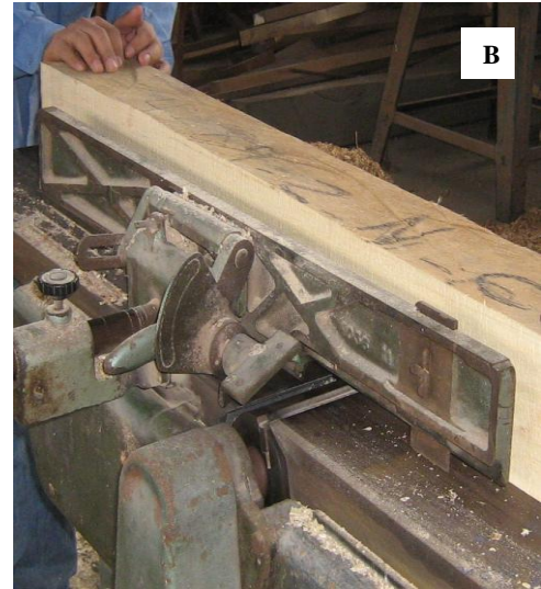
Figura 5: Transformación de trozas a viguetas (A) Corte longitudinal de las trozas para la obtención de tablonés de sección 5 pulgadas x ancho variable y 4 pies de longitud (B) Escuadrado de los tablonés para la obtención de las viguetas.
