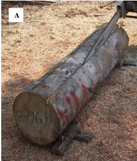
Figura 5: Transformación de trozas a viguetas (A) Corte longitudinal de las trozas para la obtención de tablonés de sección 5 pulgadas x ancho variable y 4 pies de longitud (B) Escuadrado de los tablonés para la obtención de las viguetas.
