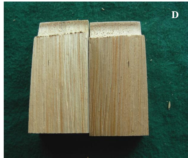
A y B. Probeta ensayada en sección radial C y D. Probeta ensayada en sección tangencial
