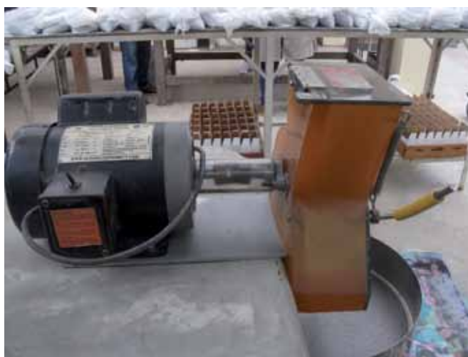
Figura 6a: Molino utilizado para la molienda y tamizado
