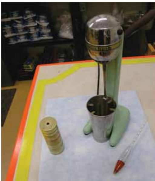
Figura 11: Dispersador (agitador), vaso e hidrómetro de Bouyoucos, empleados en el método del hidrómetro.
