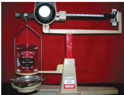
Figura 8: Pesado del agregado en agua
