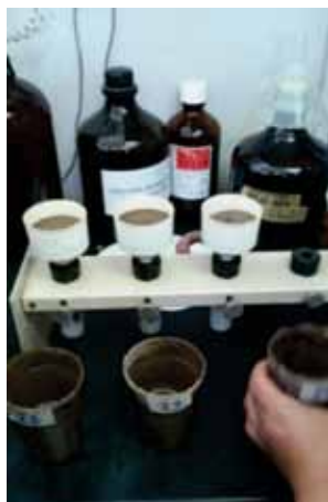
Figura 9: Embudos Büchner y colección de filtrado.
