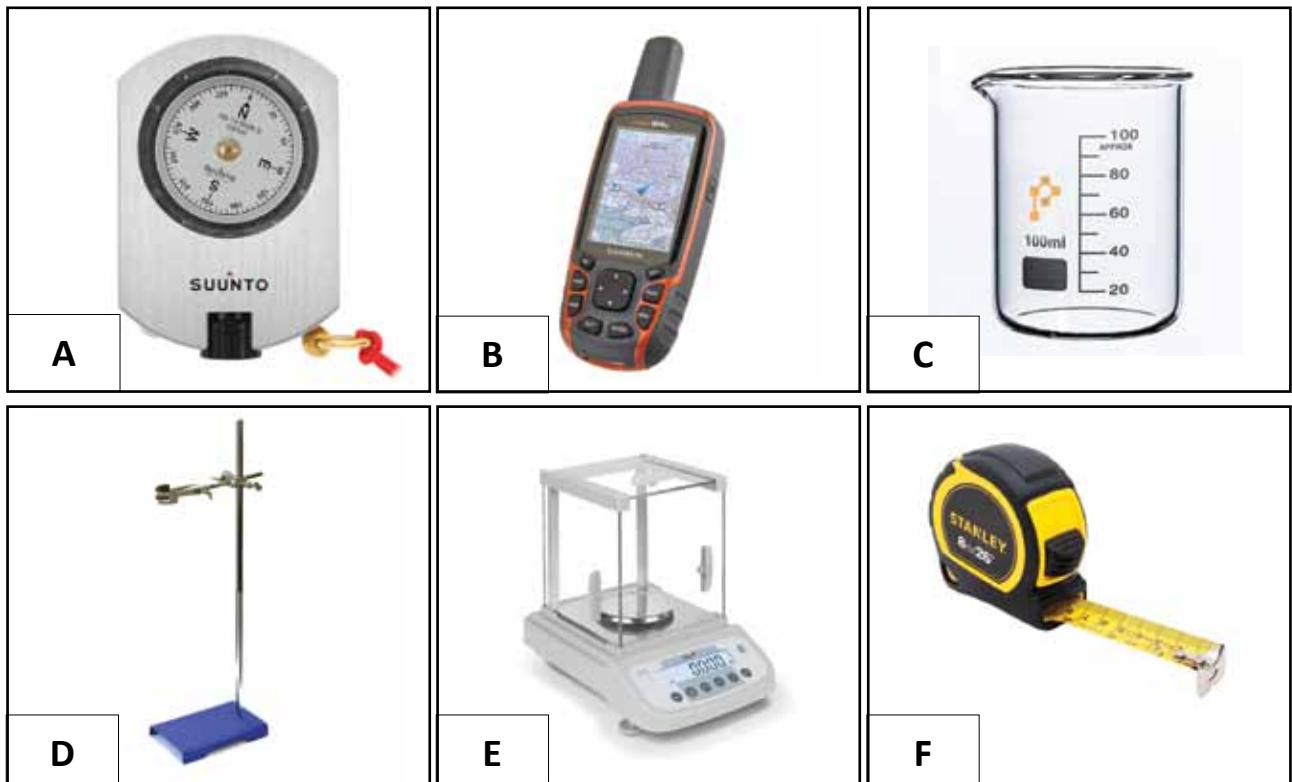
Figura 3. Materiales utilizados en la evaluación. A. Brújula Suunto. B. GPS Garmin. C. Vaso de precipitado de 100 ml. D. Soporte universal para la determinación de volumen. E. Balanza digital. F. Wincha metálica .
